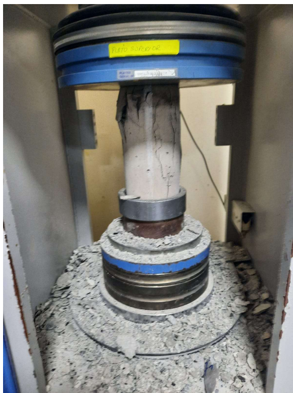
Anexo 11. Hormigón + ceniza-ensayo a compresión
