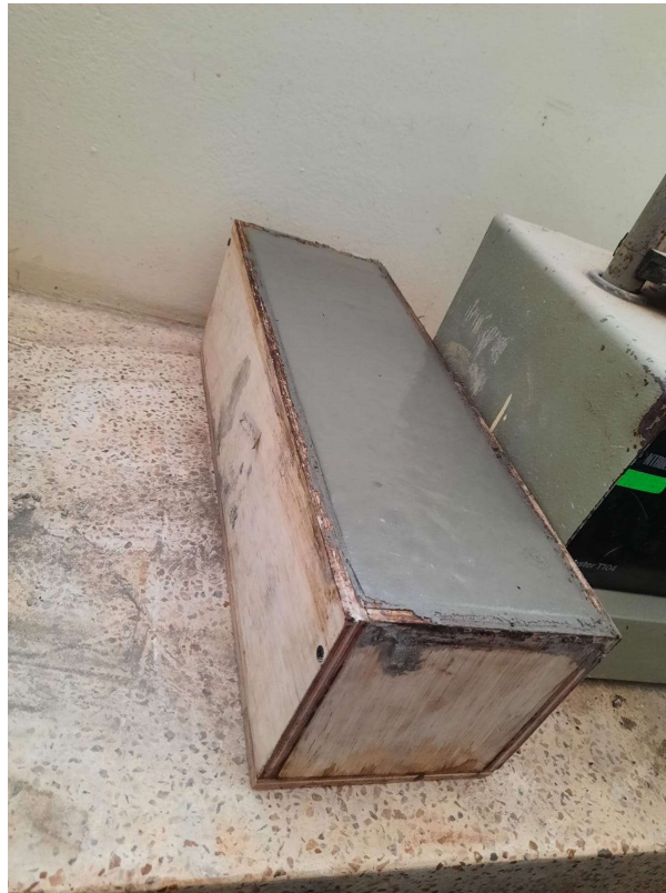
Anexo 7. Elaboración de vigas para ensayo a flexión
