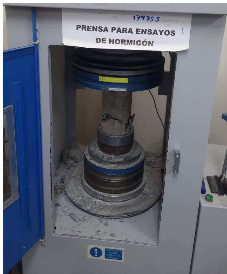
Anexo 10. Hormigón simple-ensayo a compresión
