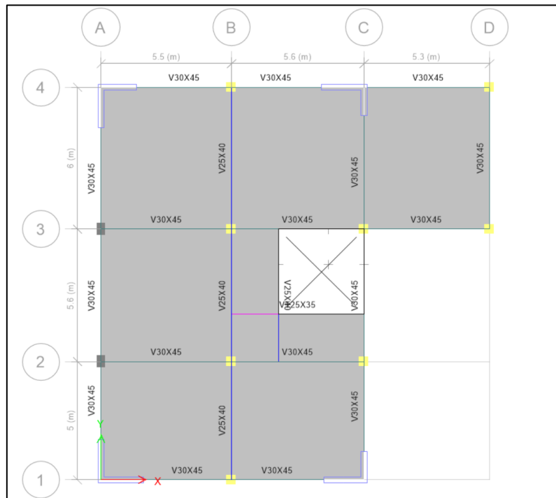
Resumen de dimensiones de secciones para piso 5
