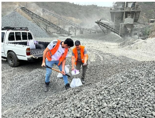
Figura 3-1 Vista General de la cantera A y extracción del agregado
