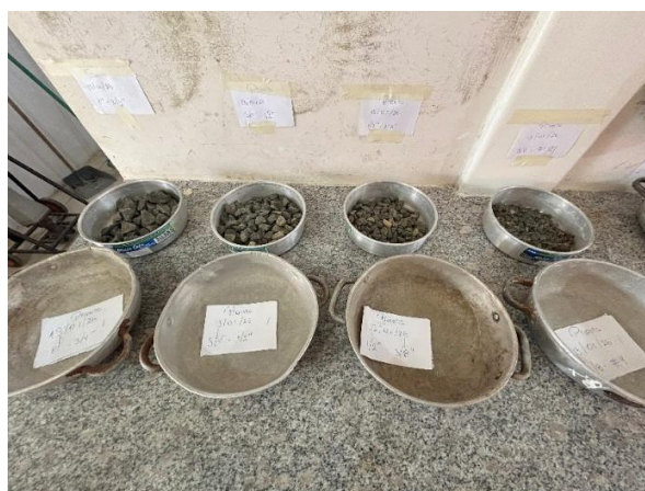
Figura 3-13 Preparación para comenzar el primer ciclo de la cantera B
