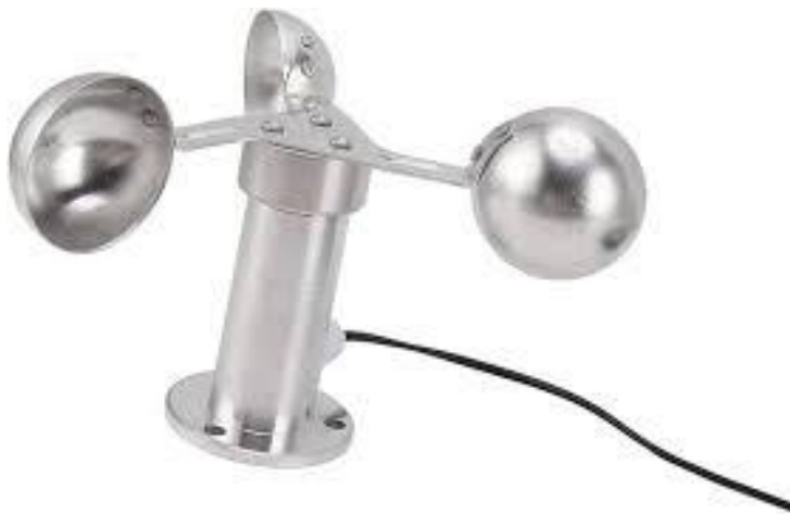
Figura 5. Anemómetro de tres tazas utilizado en la investigación.
