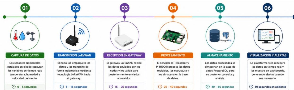
Figura 3. Flujo de transmisión de datos del sistema
