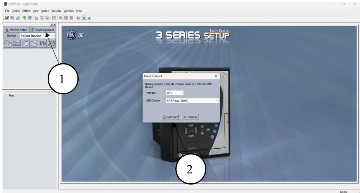
Figura 11 Enlace entre PC y software del relé multilin 345 GE.
