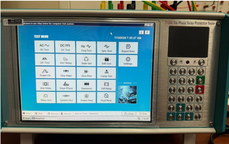
Figura 22 Menú de test de la maleta de pruebas de inyección secundaria Vluuke T1200
