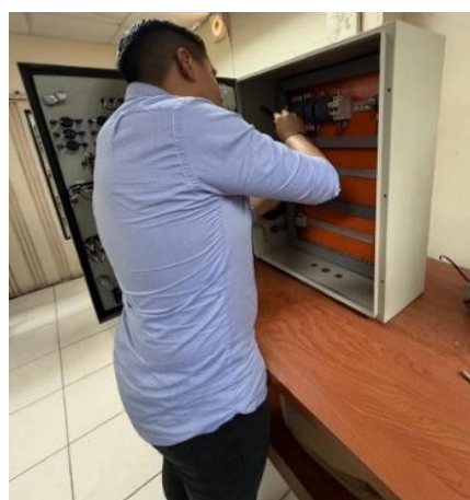
Foto 5 y 6. Fase de montaje, conexión eléctrica y programación del controlador lógico programable (PLC) en el tablero de control
