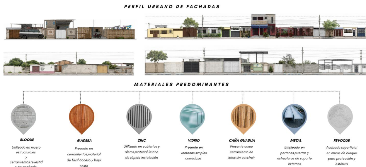
Figura 14 Materiales predominantes en las fachadas en el perfil urbano de la manzana
