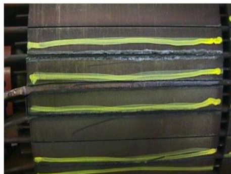
Figura 5: Rotor con diseño de barra abierta
