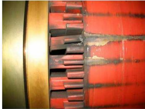
Figura 6: Rotor con diseño de barras cerrado
