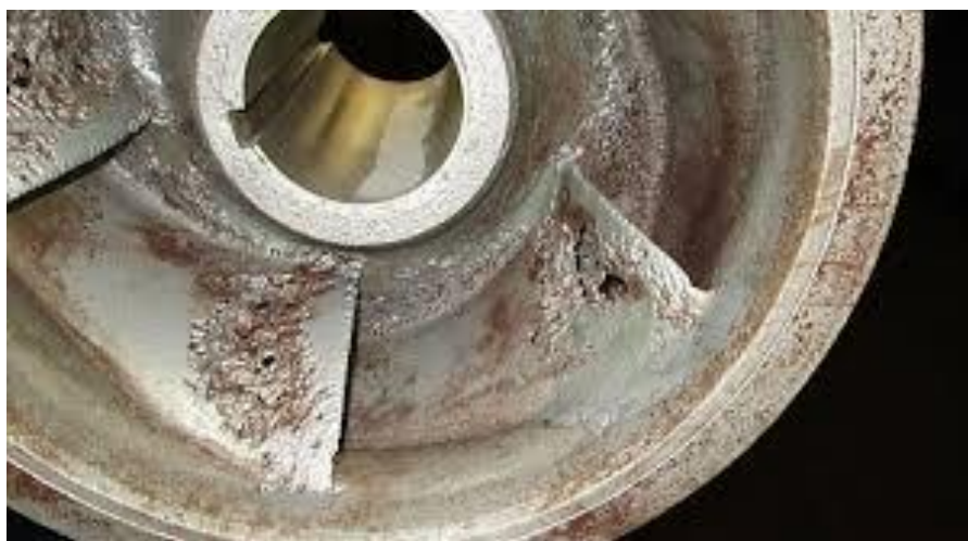
Figura 7. Daño producido por cavitación Fuente: https://www.ingenieriaquimicareviews.com/2020/05/
