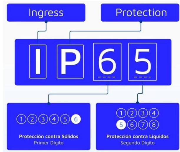
Figura 16. Grados de Protección IP Fuente: https://www.fractal.com/es/mantenipedia
