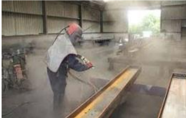
Figura 12. Limpieza con chorro abrasivo Fuente: https://www.ocitrimex.com.mx/
