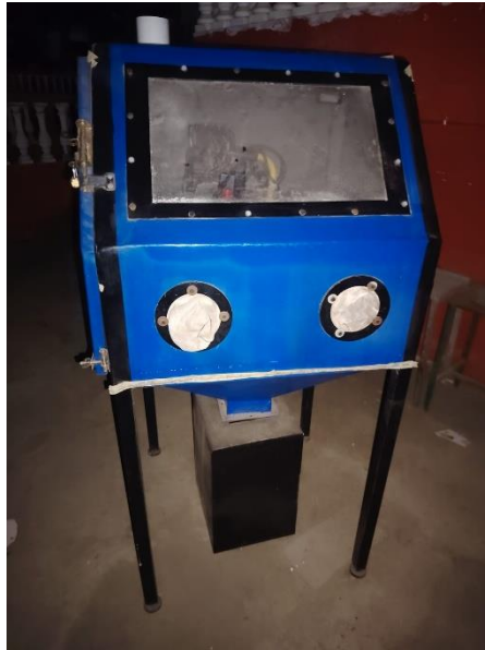
Figura 38. Cabina de sandblasting terminada. Fuente: Gavilánez y Villafuerte (2025)
