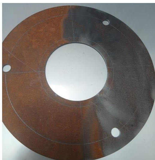
Figura 42. Resultados del proceso de granallado. Fuente: Gavilánez y Villafuerte (2025)
