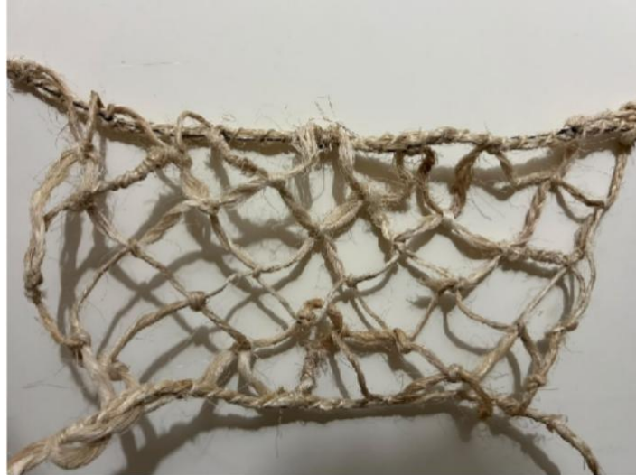
Figura 22. Segmento de red elaborada a partir de fibra de plátano Fuente: Propia
