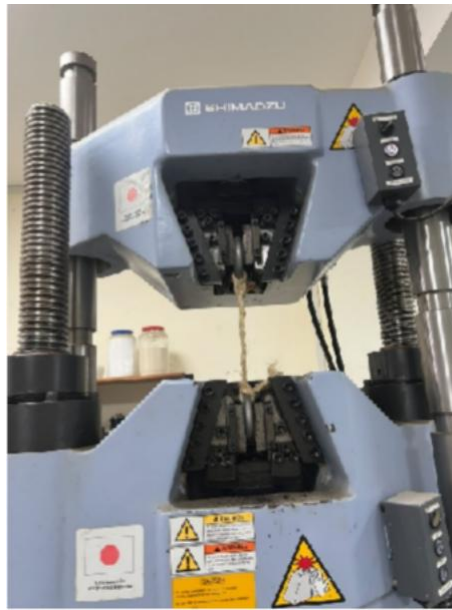
Figura 25. Prueba de tracción con la fibra de plátano Fuente: Propia
