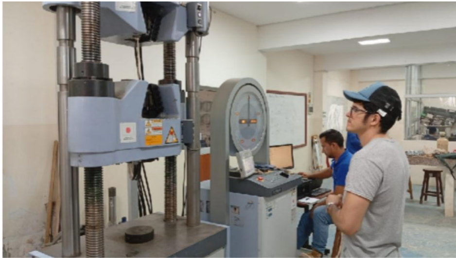
Figura 26. Revisión de prueba de tracción Fuente: Propia
