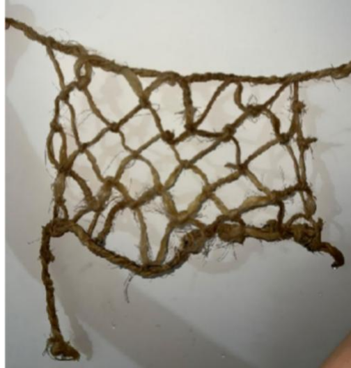
Figura 23. Red de fibra de plátano expuesta a la humedad Fuente: Propia
