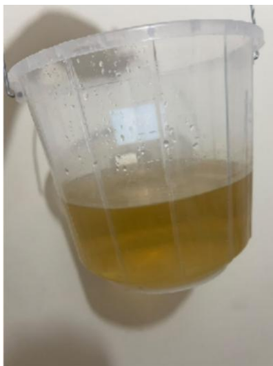
Figura 24. Coloración del agua producto de la exposición continua de la fibra Fuente: Propia
