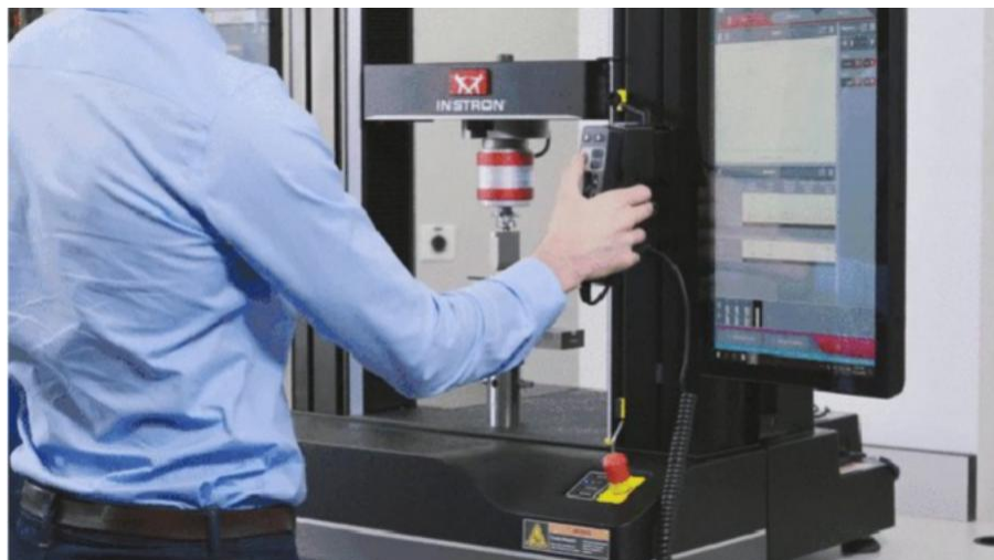
Figura 17. Máquina para ensayos de tracción Fuente: https://www.instron.com
