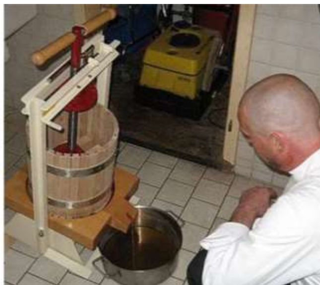
Figura 3. Extracción de la miel por compresión
