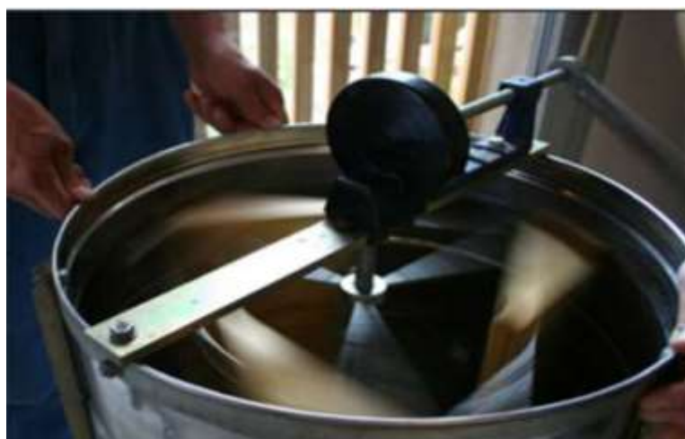
Figura 4. Extracción de la miel por método de centrifugación
