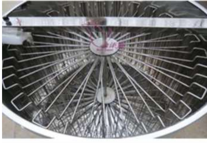
Figura 5. Centrifugadora para extracción de miel tipo radial
