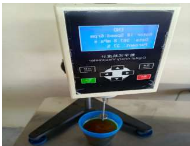
Anexo 8. Medición de la viscosidad de la miel clara con viscosímetro rotacional digital
