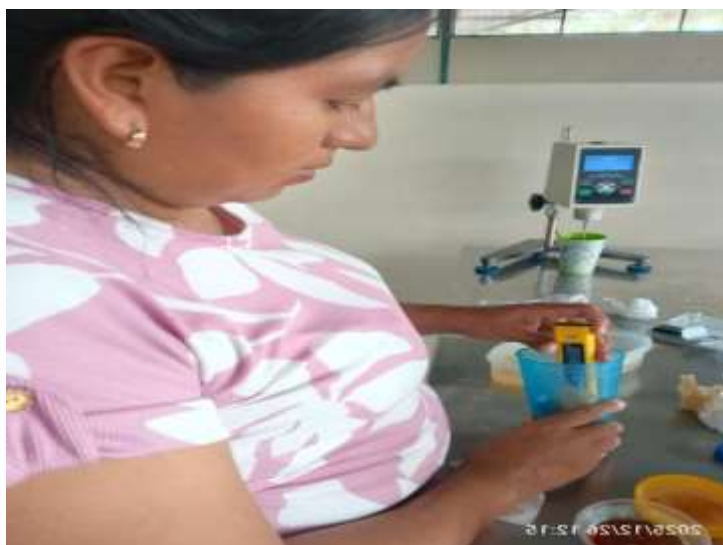
Anexo 6. Determinación del pH de la miel clara mediante pH-metro digital
