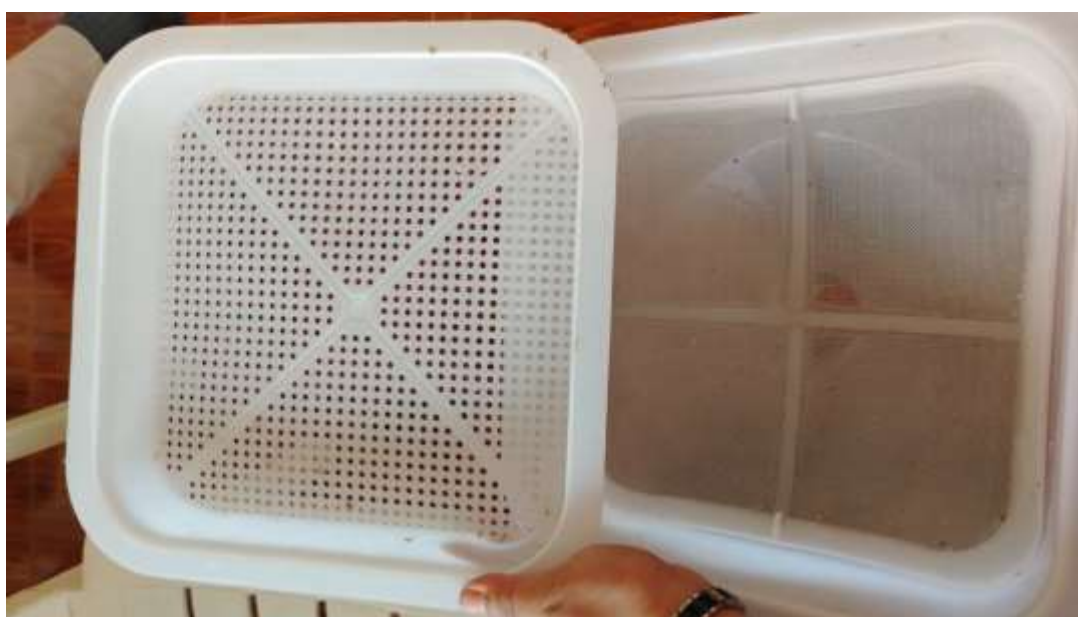
Figura 10. Filtros plásticos de doble malla utilizados para el proceso de purificación y clarificación de miel
