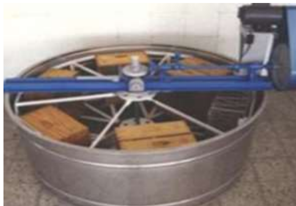
Figura 6. Centrifugadora de miel tipo paralelo radial
