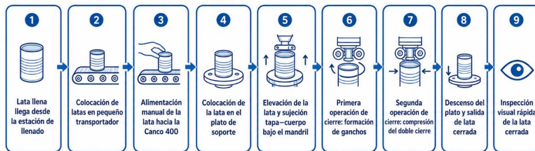
Diagrama de flujo de la cerradora
