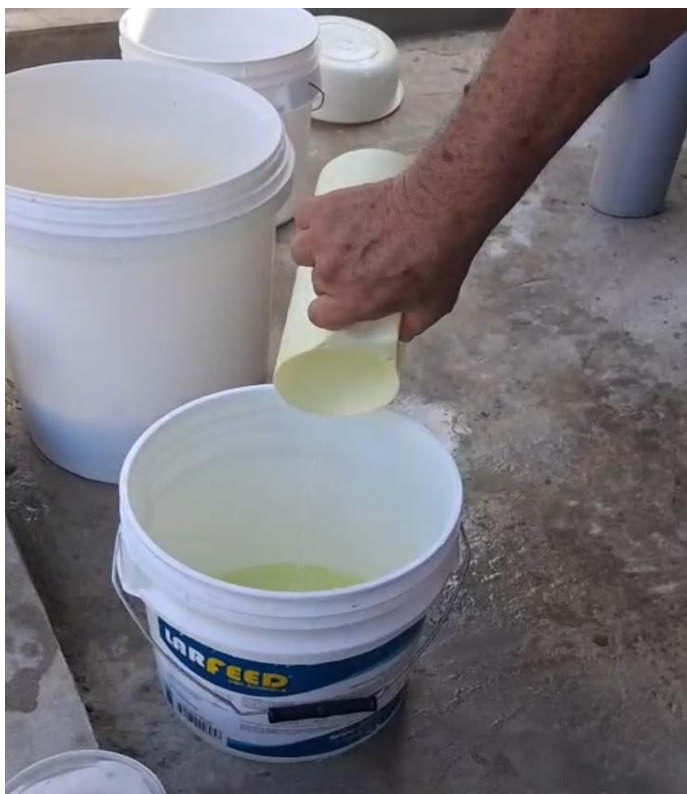
Ilustración 3 Preparacion del hipoclorito de sodio
