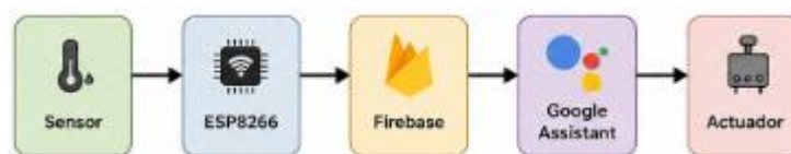
Ilustración 2: Diagrama de bloques de procesos de comunicación IoT.
