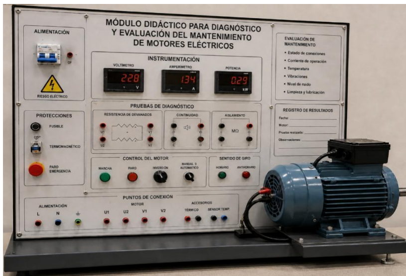
Figura. 6 Configuración final del módulo didáctico y del motor eléctrico montado sobre la base.
