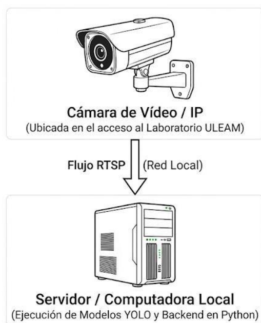
Ilustración 9 interconexión de la infraestructura de hardware y captura de vídeo. Fuente: Elaboración propia (2026).
