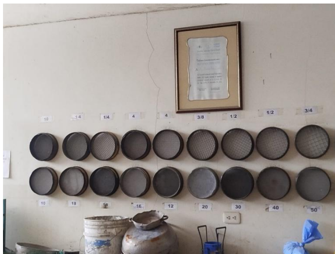
Figura 2.5.- Tamices, Laboratorio de suelos ULEAM.
