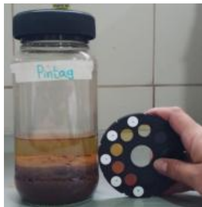
Figura 0.7.- Prueba de impurezas inorgánicas en el agregado fino.
