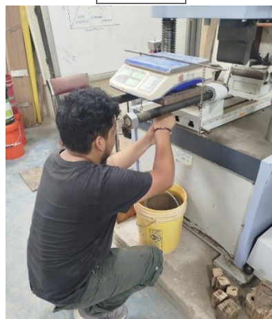
Figura 2.10.- Peso Sumergido de la Piedra Pómez SSS.
