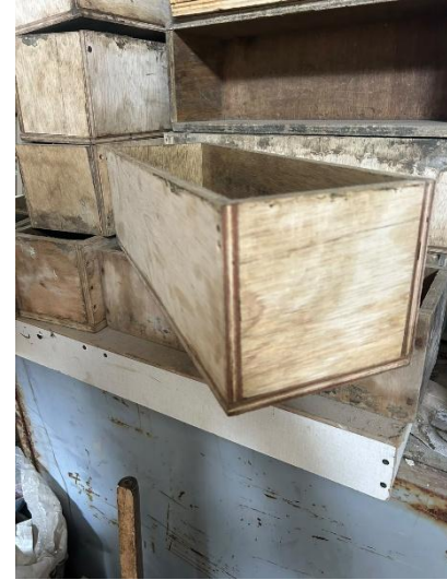
Figura 2.13.- Molde de Viga.
