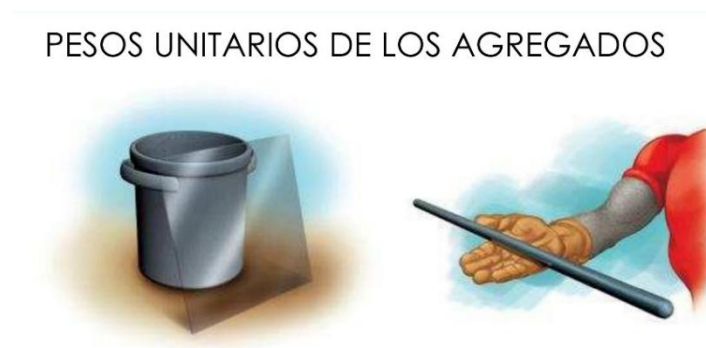
Figura 0.3.- Materiales utilizados en el ensayo de Peso Unitario.
