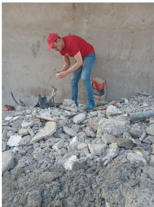
Anexo 29 Recolección de muestra de RCD en zona local
