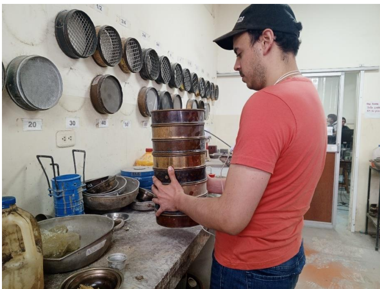
Anexo 13 Ensayo de Granulometría de áridos
