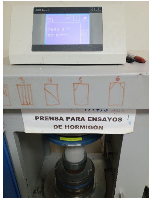
Anexo 27 Ensayo destructivo de compresión
