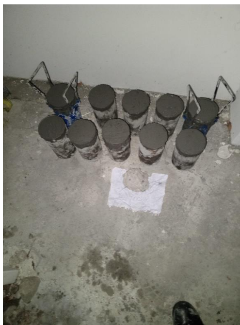
Anexo 22 Probetas con 50% de sustitución de RCD
