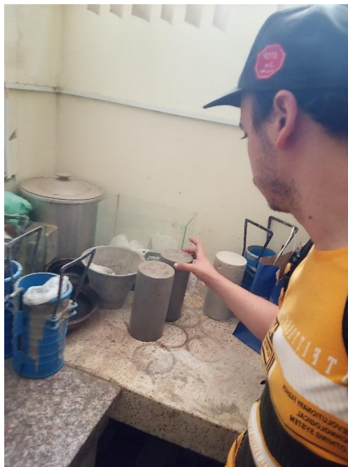
Anexo 20 Proceso de secado para ensayar 24 horas después
