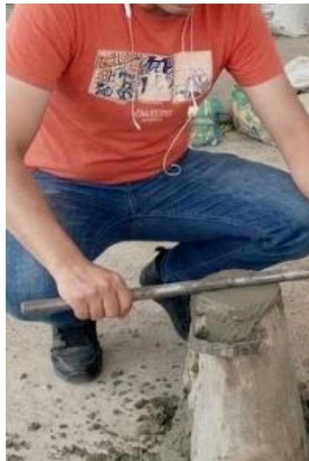
Anexo 16 Ensayo de revenimiento
