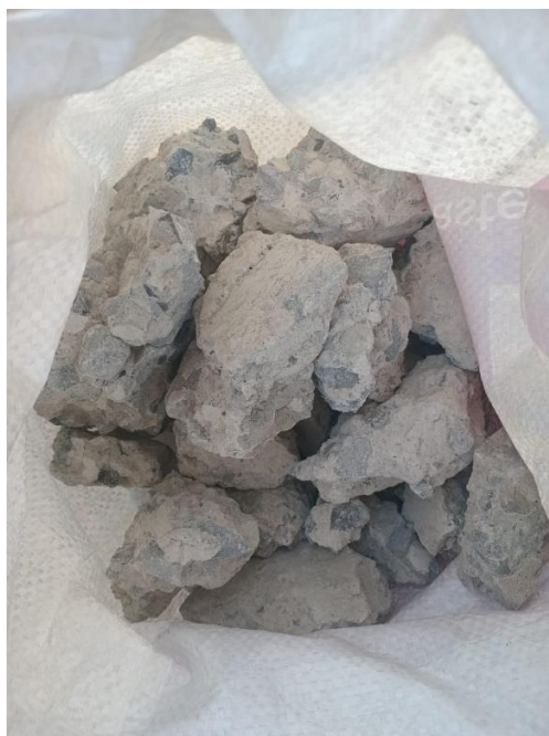
Anexo 7 Árido reciclado de RCD con mortero adherido
