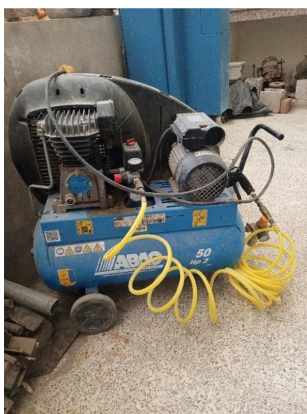
Anexo 24 Compresor de aire
