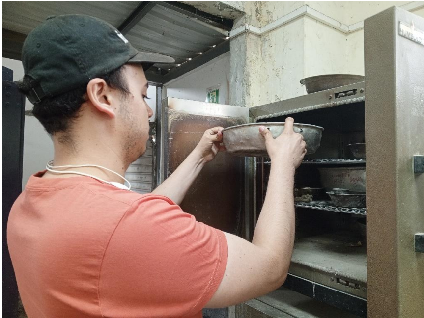
Anexo 11 Ensayo de contenido de humedad
