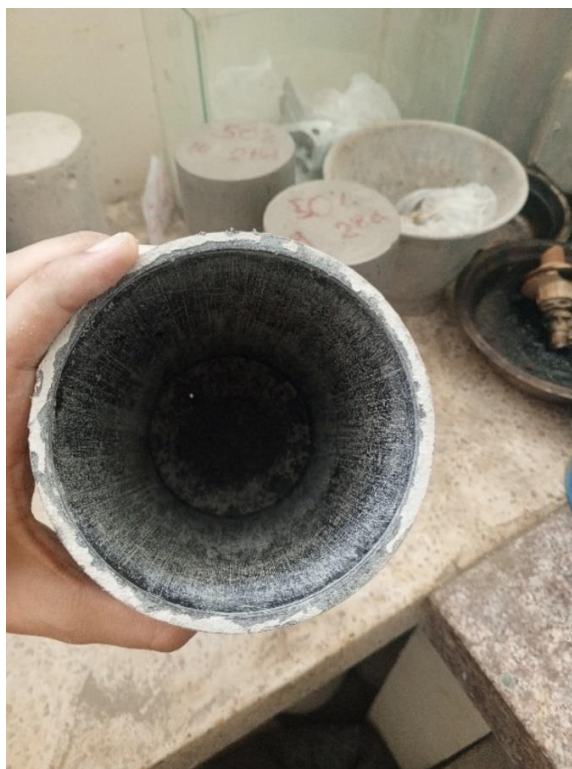
Anexo 23 Moldes de plástico para probetas de 10x20 cm con abertura para desmoldar con compresor de aire
