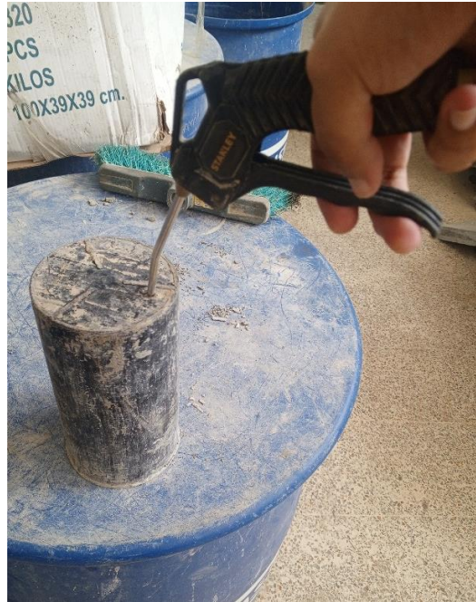
Anexo 25 Desmoldeo con compresor de aire
