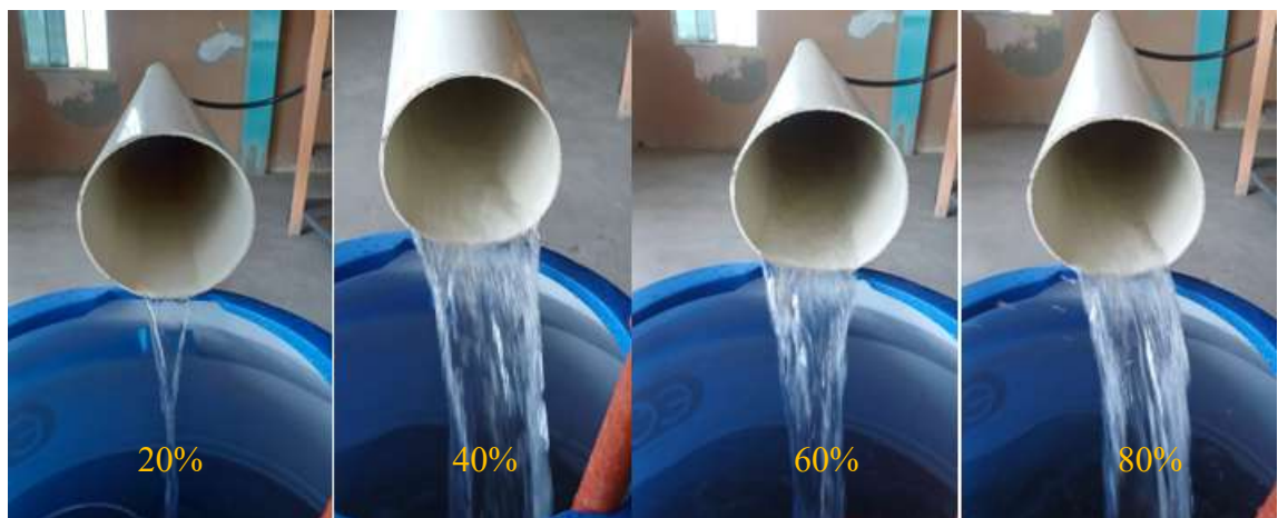
Figura 10 Comportamiento del flujo a salida de tubería de PVC para diferentes porcentajes de apertura.
