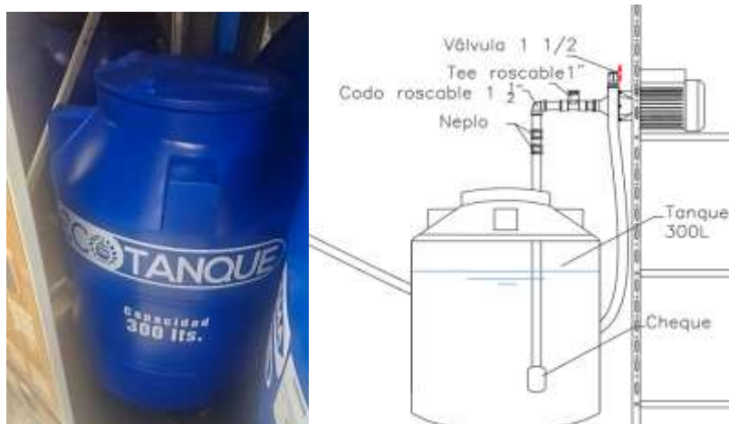
Figura 5 Tanque de almacenamiento
