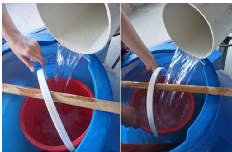
Figura 9 Método de aforo volumétrico.
