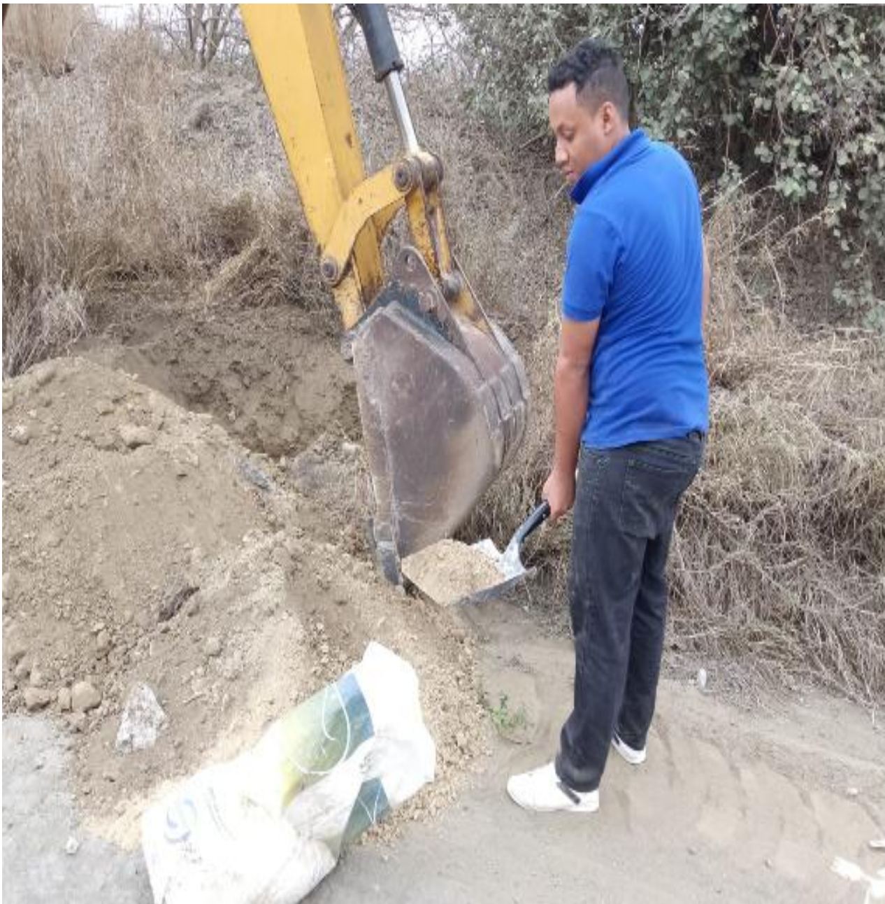
Figura 70 Extracción de muestras para estudio de suelos en la Vía Antigua del Chorrillo
