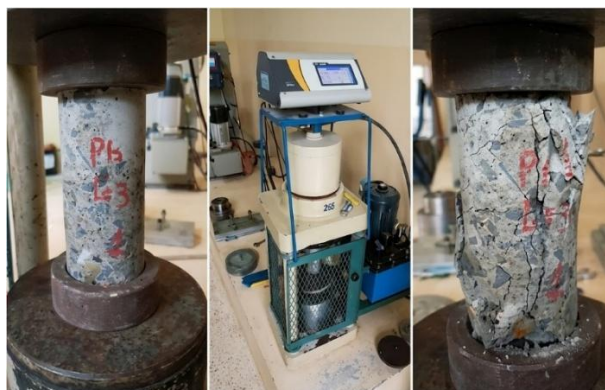
Ilustración 9 Ensayo de la resistencia del hormigón a la compresión, en medio, máquina de ensayo. Fuente: Del Castillo (2018)
