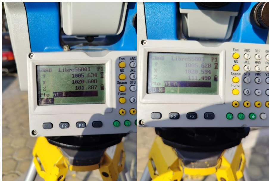
Ilustración 99 Ejes X, Y y Z en la columna A1.
