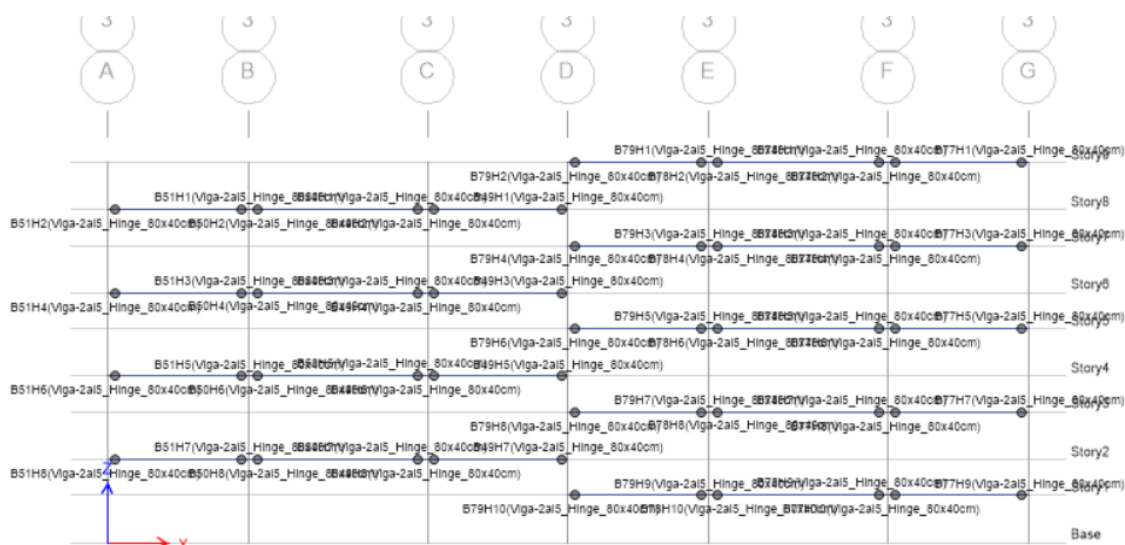
Ilustración 65 Hinges en las vigas del eje 3
