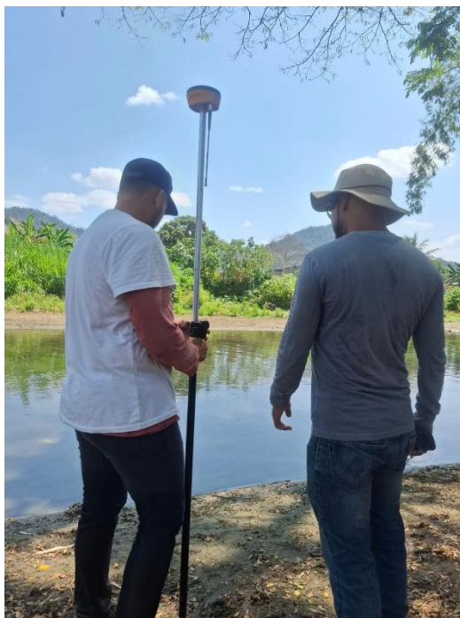
Anexo 3. Levantamiento topográfico mediante equipo GNSS en las zonas de ribera seca, recabando datos para el procesamiento del terreno.
