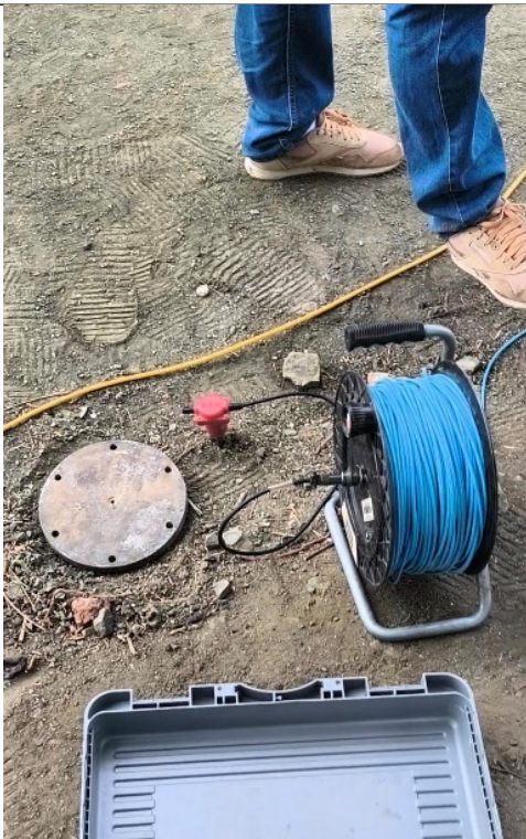
Fotografía 4. Preparación inicial del equipo de refracción sísmica
