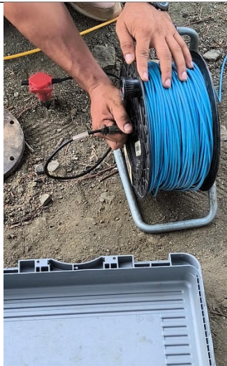
Fotografía 5. Despliegue y organización del cable sísmico
