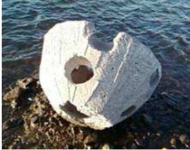
Fotografía 5.2.1.- Domo de concreto, utilizado en la presente investigación. (Fuente: Autores de tesis)
