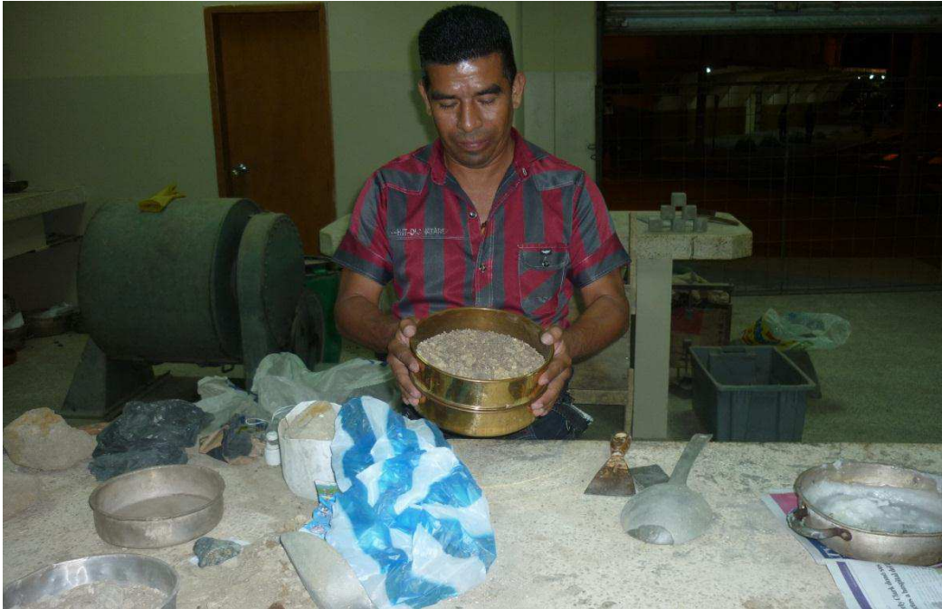
Ilustración 49: Se realiza la clasificación granulométrica de la muestra de suelo en estudio por medio de los tamices Elaborado por: Los Autores
