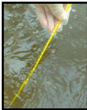
**Figura #35. Termómetro para medir la temperatura del agua. Fuente: Autores de tesis**
