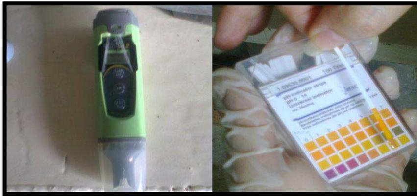
Figura #36. pHmetro y tiras de medición de pH. Fuente: Autores de tesis
