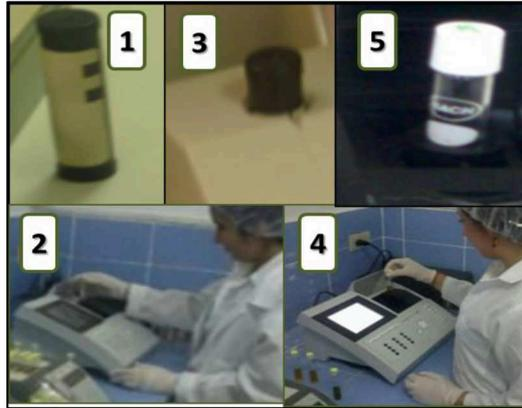
Figura #42. Procedimiento para el análisis de las muestras de agua de cultivo de larvas de camarón. Fuente: Autores de tesis
