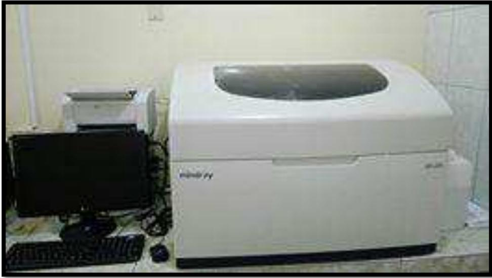
**Ilustración 5** Mindray bs-200 equipo automatizado para Bioquímicos.
