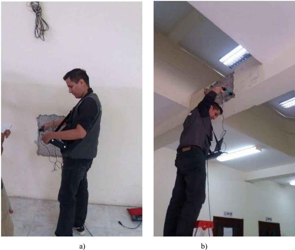
Figura 45. Escaneo estructural; a) Escaneo en columnas; b) Escaneo en vigas; Fuente: Autores
