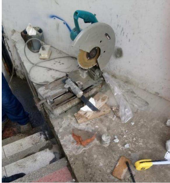
Figura 43. Corte de los especímenes extraídos; Fuente: Autores.
