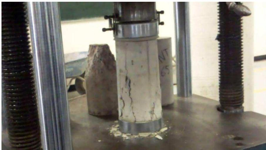
Figura 29. Resistencia a la compresión del hormigón; ensayo de cilindros;
