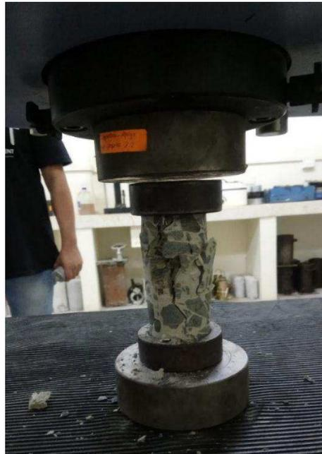
Figura 44. Especimen de hormigón ensayado; Fuente: Autores.
