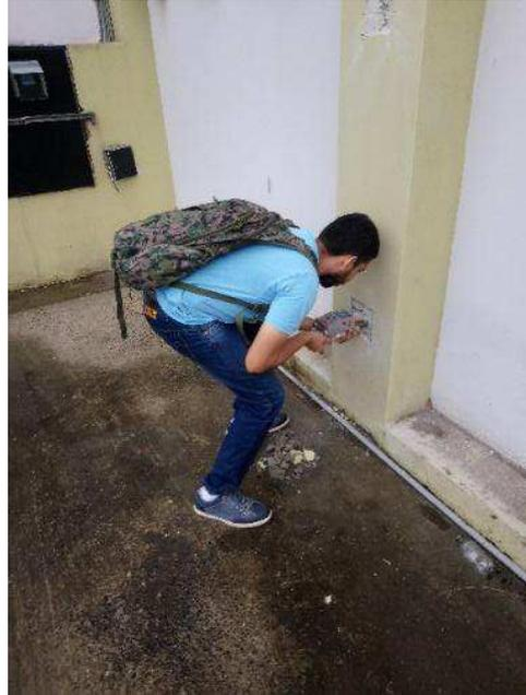
Figura 41. Ensayo de esclerometría en columna;
