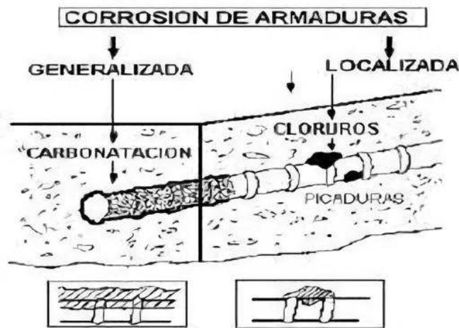
Figura 6. Corrosión localizada de armaduras por ataque de cloruros.
