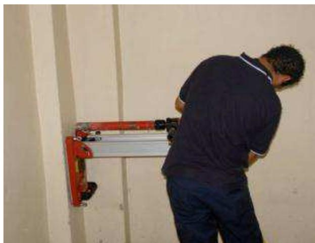
Figura 27. Preparación del equipo para la extracción de núcleos;
