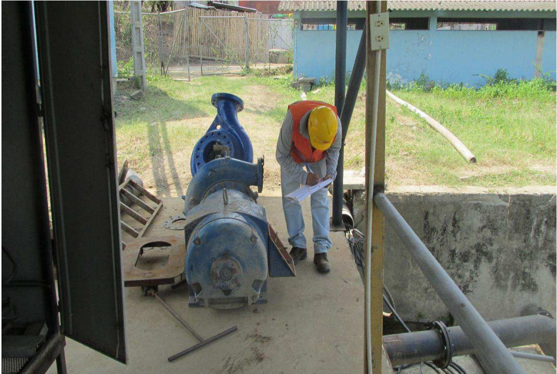
Investigador Julio Bravo tomando datos de la placa de características de la bomba sumergible
