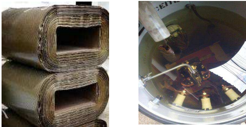
Figura1. 2 Estructura interna de un transformador Monofásico.
