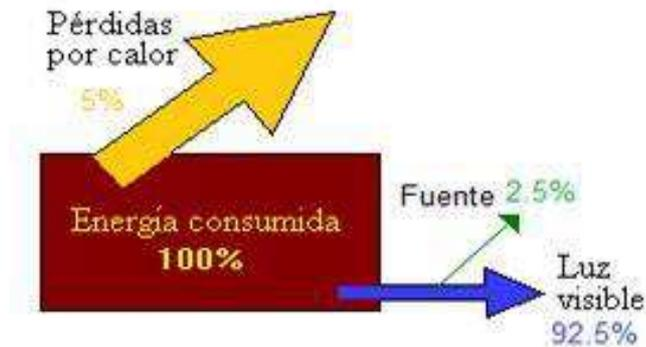
**Figura 3.4:** Balance energético de una lámpara de LED
