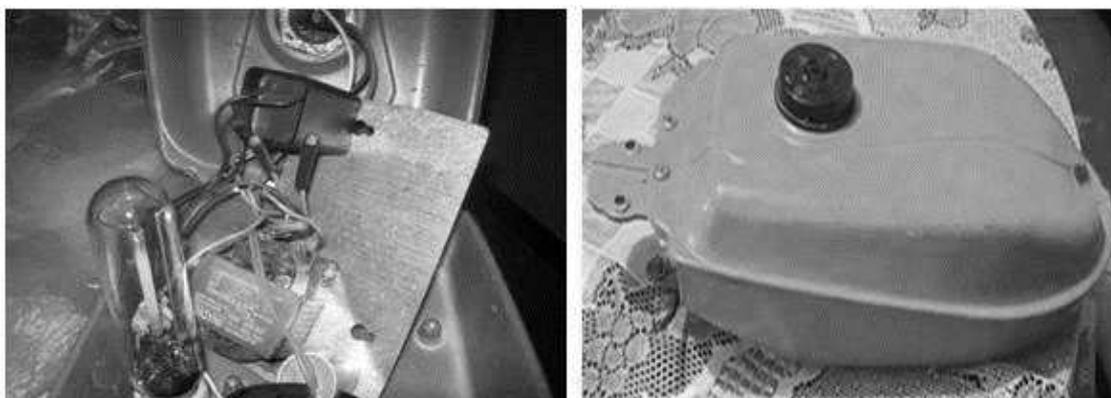
**Figura N° 3.6:** Lámpara de vapor de sodio de 150W utilizada en el estudio con sus componentes principales y descripción de carcasa.
