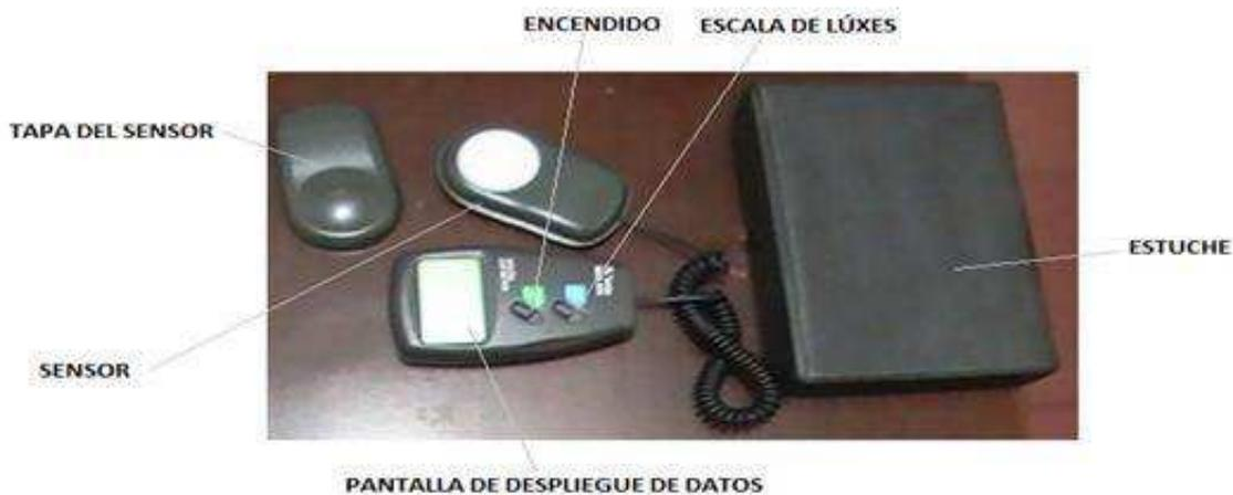
**Figura N° 3.8:** Luxómetro utilizado en el planteamiento.
