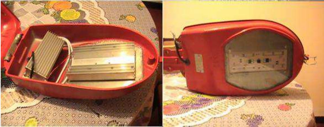
**Figura N° 3.7:** Lámpara de LED de 90W utilizada en el estudio con su respectiva carcasa y componentes.
