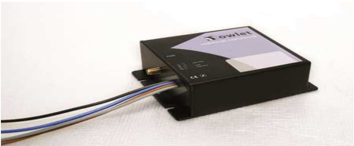
Figura N°6: Controlador de luminaria.
