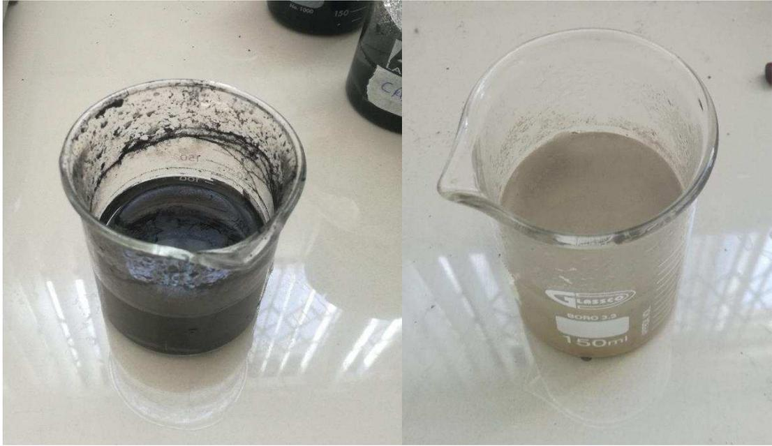
*Fotografía 12 Post remoción mediante bach, carbón activado y fracción mineral*
