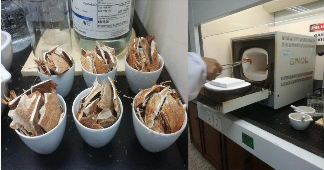
*Fotografía 3 Colocación del endocarpo de coco en los crisoles y entrada a la mufla*
