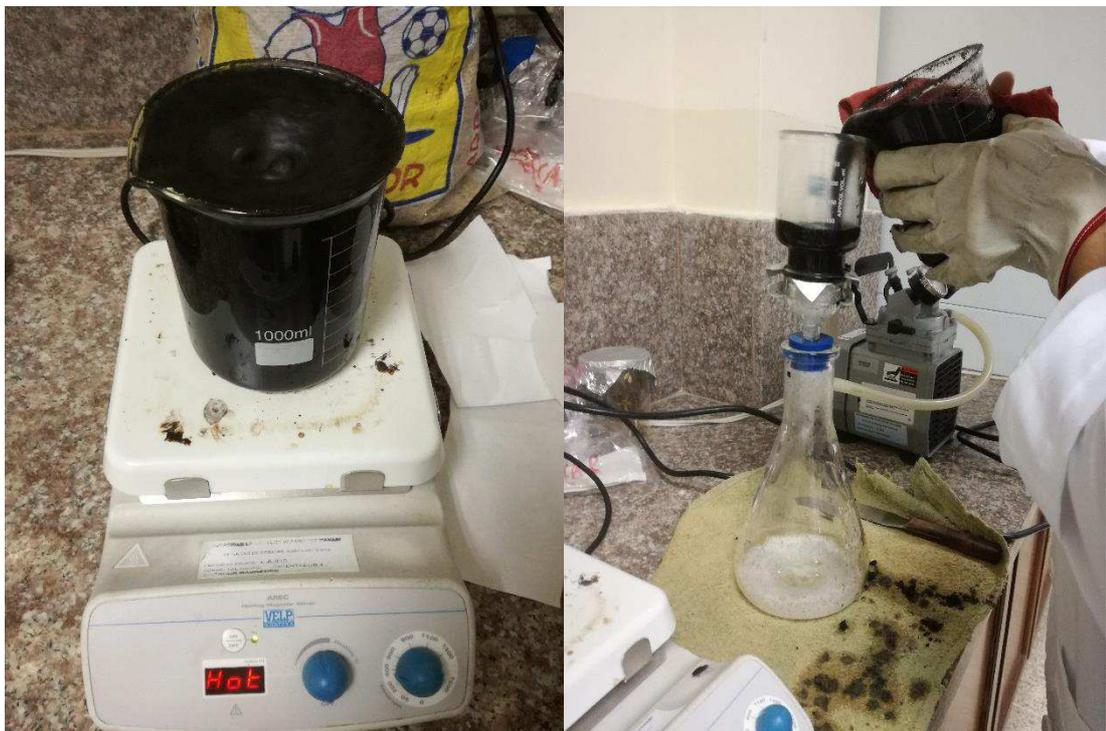
*Fotografía 6 Lavado y filtración del carbón activado de coco*
