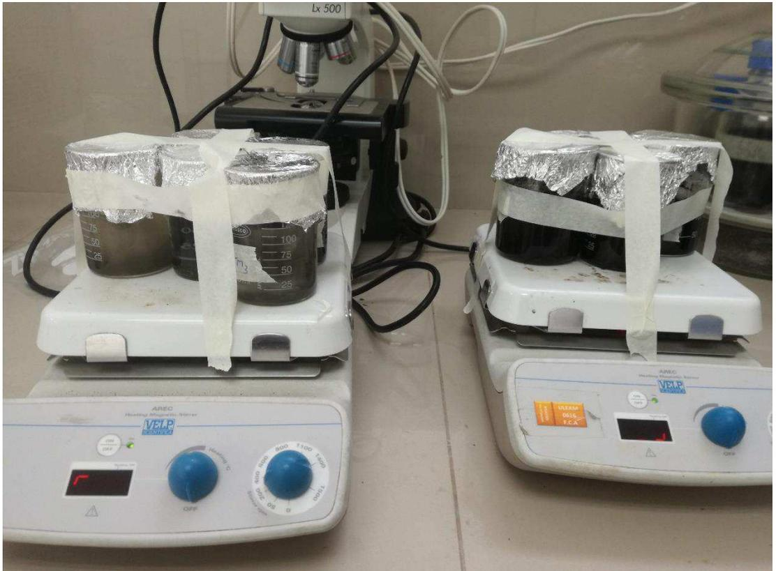
Fotografía 10 Montaje de los ensayos por carga (Bach) y sus réplicas
