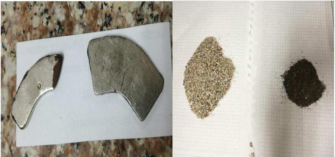
*Fotografía 4 Imán de neodimio y separación de la fracción mineral de la arena*
