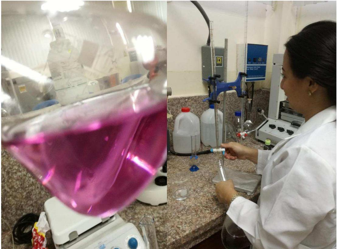
*Fotografía 11 Realización de análisis de dureza cálcica y cloruros*
