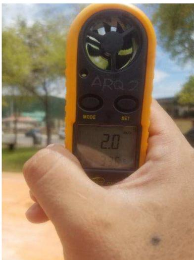
**Ilustración 26:** medidor de vientos (BENETECH GM816).
