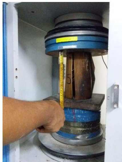
Ensayos a compresión en la prensa para ensayos de hormigón
