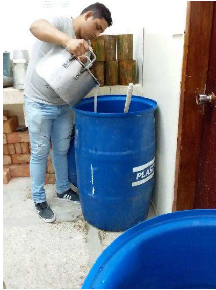
Figura 28. Vaciado del bórax y ácido bórico al recipiente de agua Fuente: Los Autores
