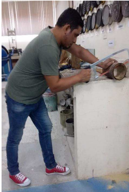
Corte de las probetas secas y aplicación de la cúrcuma
