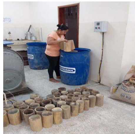
Colocación de las probetas verdes y secas a los tanques para el preservado
