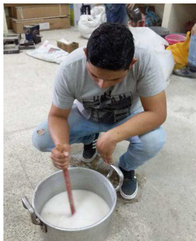
Figura 27. Mezclado de bórax y ácido bórico con agua caliente
