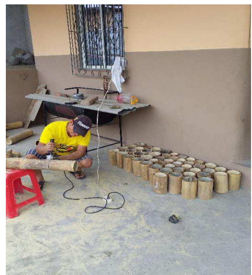
Corte de la caña guadua en probetas de 20cm de altura
