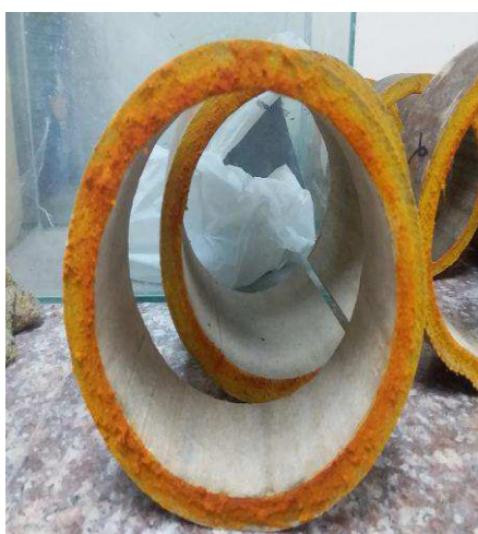
Penetración de la cúrcuma en la caña guadua
