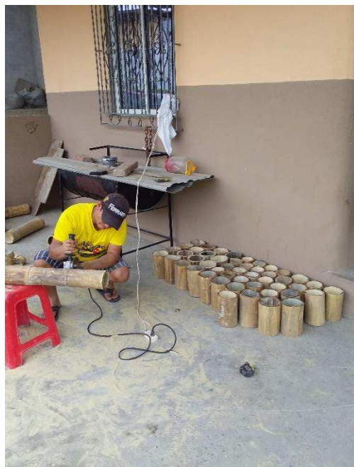
Figura 45. Cortado de las probetas (caña seca) Fuente: Los Autores
