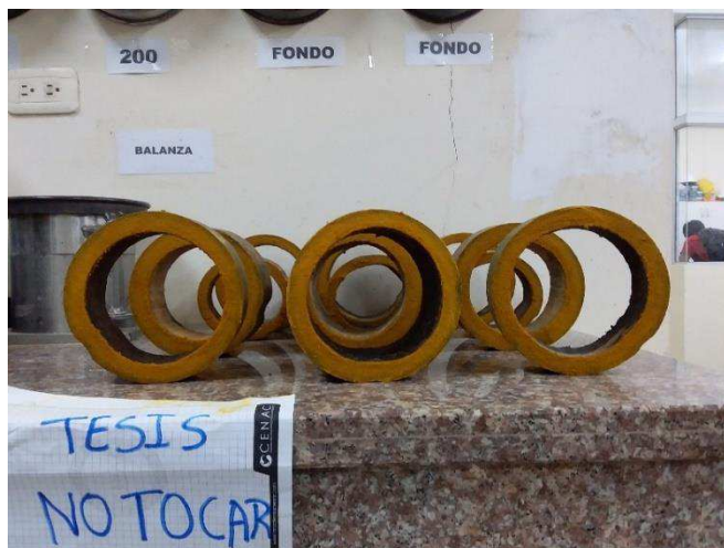
Figura 36. Probetas a las que se les aplicó cúrcuma Fuente: Los Autores
