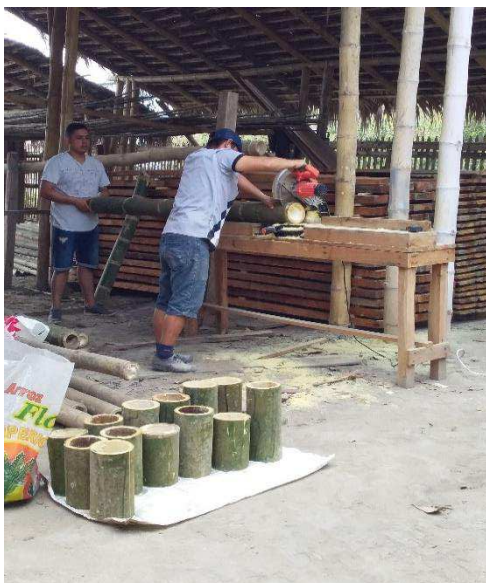
Corte de la caña guadua en probetas de 20cm de altura
