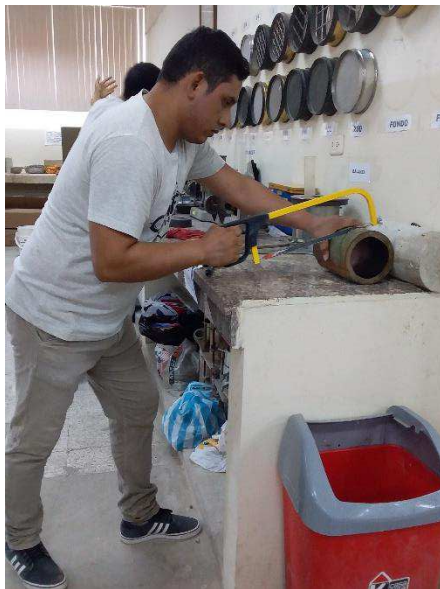
Corte de las probetas verdes para aplicarle cúrcuma
