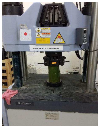
Ensayos a compresión en la máquina universal
