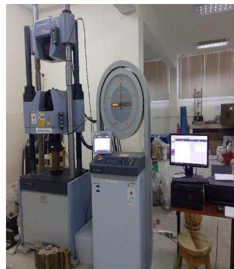
Ensayos a compresión en la máquina universal
