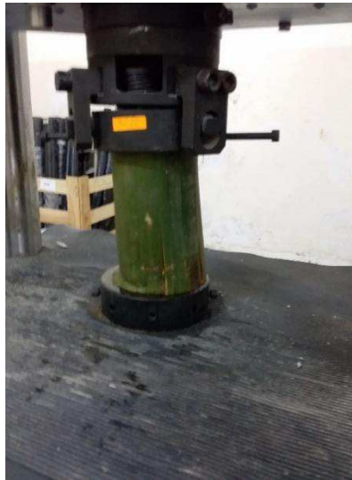
Figura 37. Probeta ensayada a compresión en máquina universal Fuente: Los Autores
