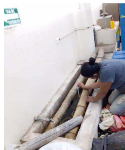
Medición de temperatura con el termómetro para verificar el preservado en agua caliente
