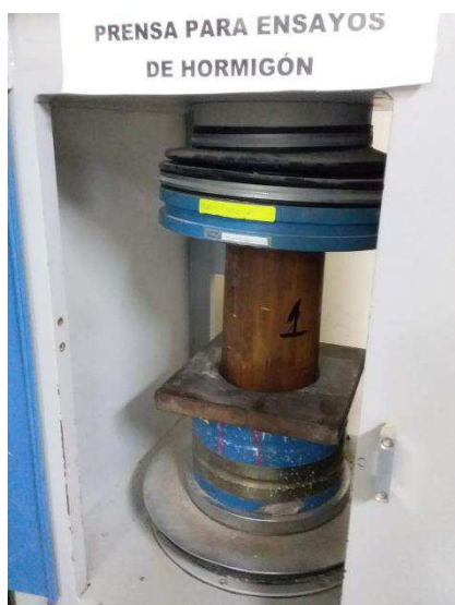
Ensayos a compresión en la prensa para ensayos de hormigón
