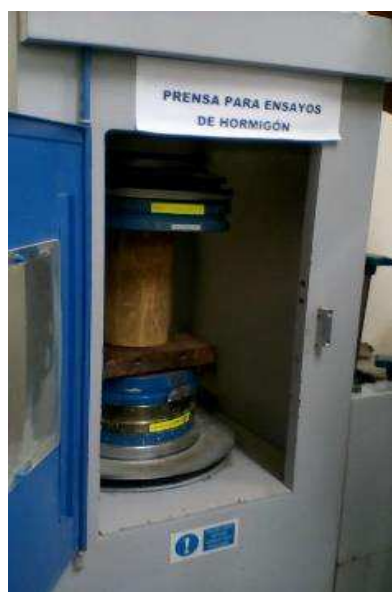
Figura 48. Ensayo a compresión en la prensa para ensayos de hormigón (caña seca)
