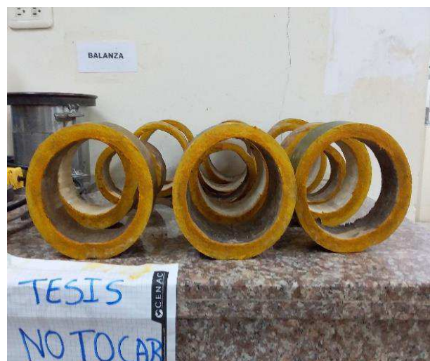
Aplicación de cúrcuma para verificar la penetración de bórax y ácido bórico
