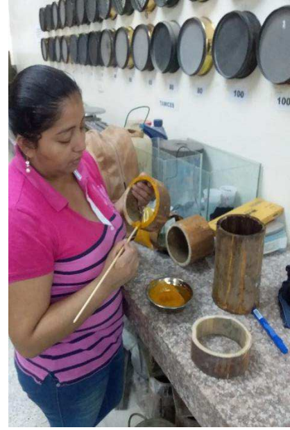
Corte de las probetas secas y aplicación de la cúrcuma
