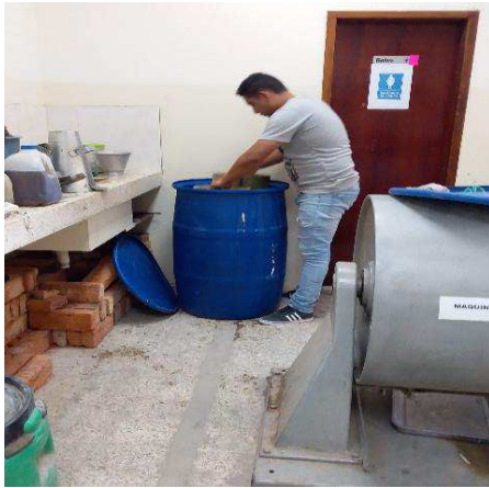
Colocación de las probetas verdes y secas a los tanques para el preservado
