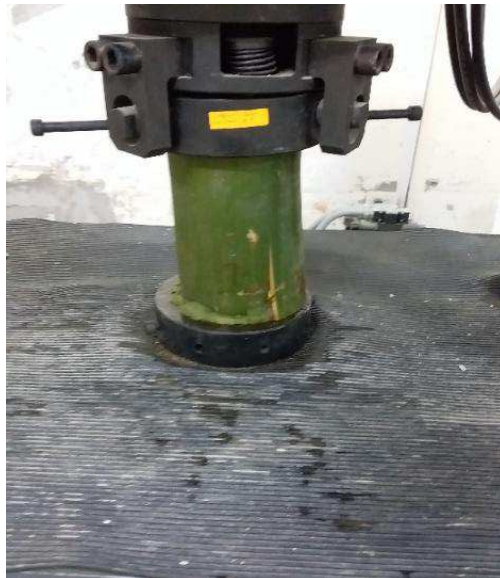
Figura 47. Ensayo a compresión en la máquina universal (caña verde) Fuente: Los Autores
