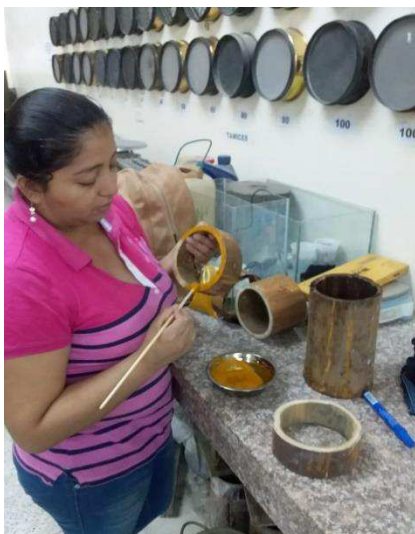
Aplicación de cúrcuma para verificar la penetración de bórax y ácido bórico
