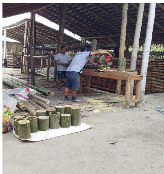
Figura 41. Cortes de las probetas (caña verde) Fuente: Los Autores
