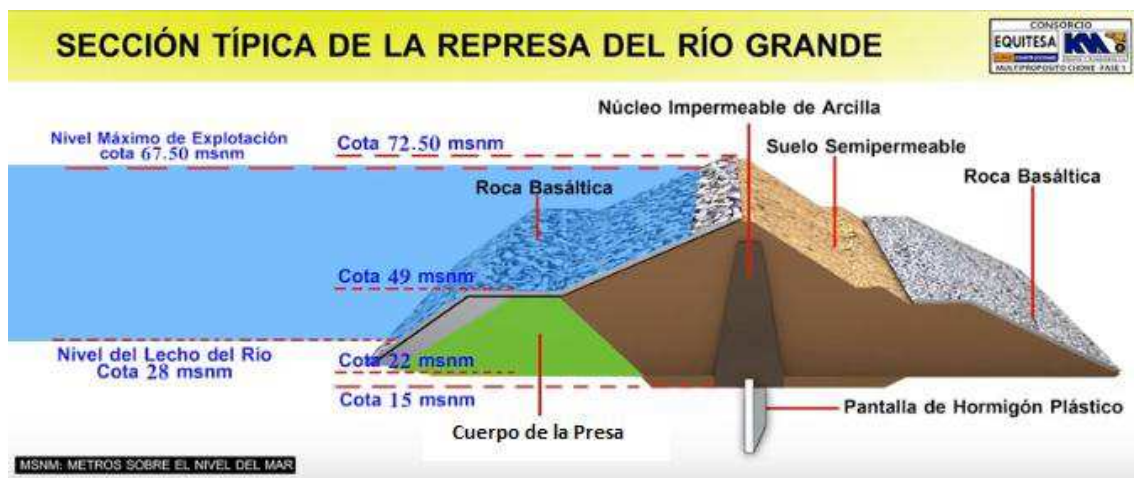
FIGURA 4: Sección Típica de la Presa Rio Grande.
