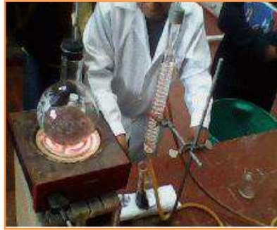
Figura 6: Proceso de destilación para determinar el porcentaje de proteína
