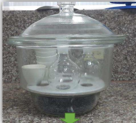
Figura 20. Extracción de la humedad en el desecador
