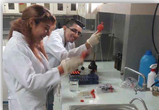
Figura 25. Preparación de los tubos para DQO
