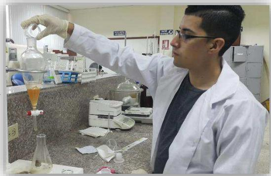
Figura 14. Colocación del efluente en el embudo de decantación con hexano.
