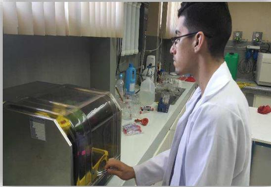
Figura 29. Determinación de DBO colocación de las botellas en la incubadora por 5 días
