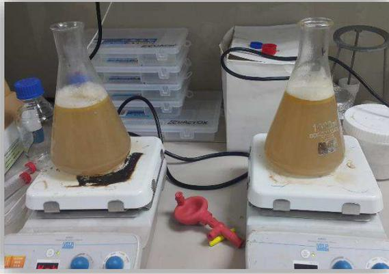
Figura 6. Montaje de las unidades en los agitadores magnéticos con sus respectivos imanes
