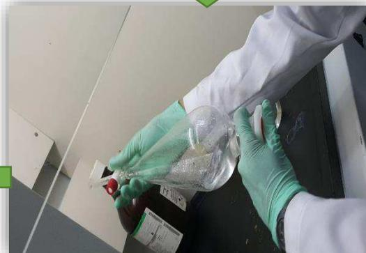
Figura 15. Extracción de gases del embudo de decantación en la sorbona
