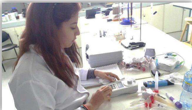
Figura 23. Determinación de turbidez en el espectrofotómetro de Merck
