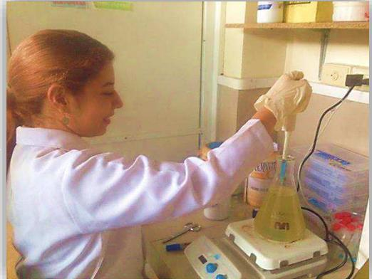
Figura 7. Adición del agente coagulante y floculante a la unidad a través de una micropipeta
