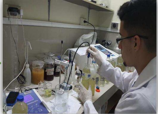
Figura 12. Determinación de sólidos disueltos Totales
