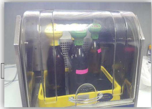
Figura 30. Incubación de la DBO5
