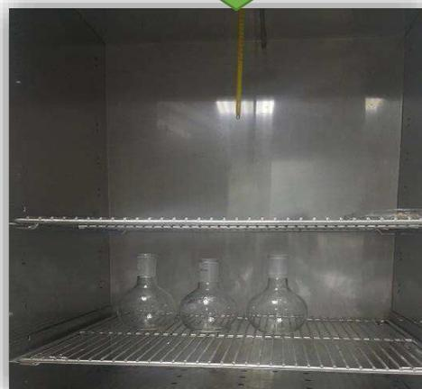
Figura 19. Secado en la estufa a 105 grados
