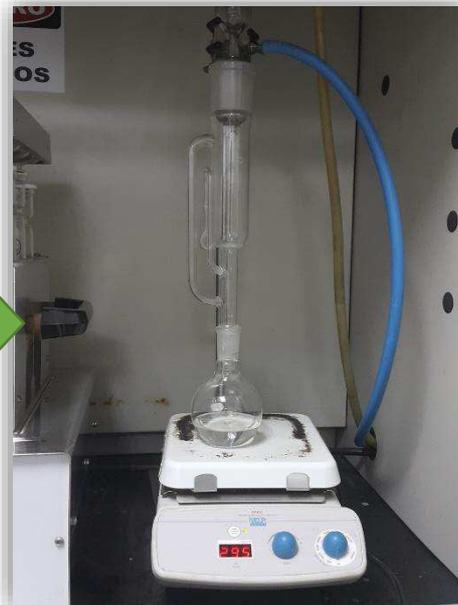
Figura 18. Recuperación del Hexano en el extractor soxhlet
