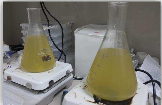
Figura 8. Proceso de coagulación y floculación con velocidad rápida de 1 minuto y velocidad lenta de 15
