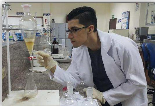
Figura 16. Separación del efluente con el hexano y la grasa
