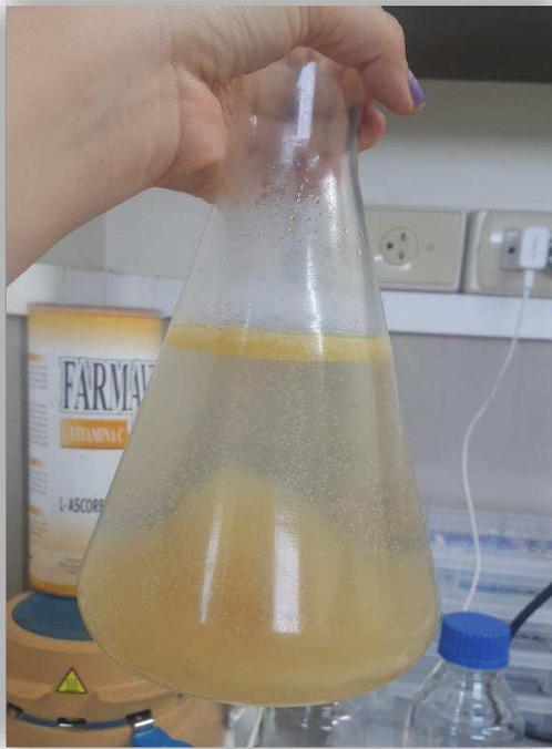
Figura 9. Formación de los flóculos y sedimentación de los mismos en 20 minutos de reposo.
