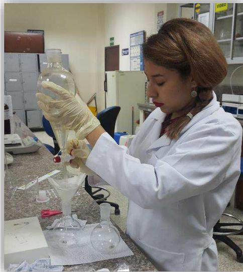
Figura 17. Filtración de hexano con la grasa
