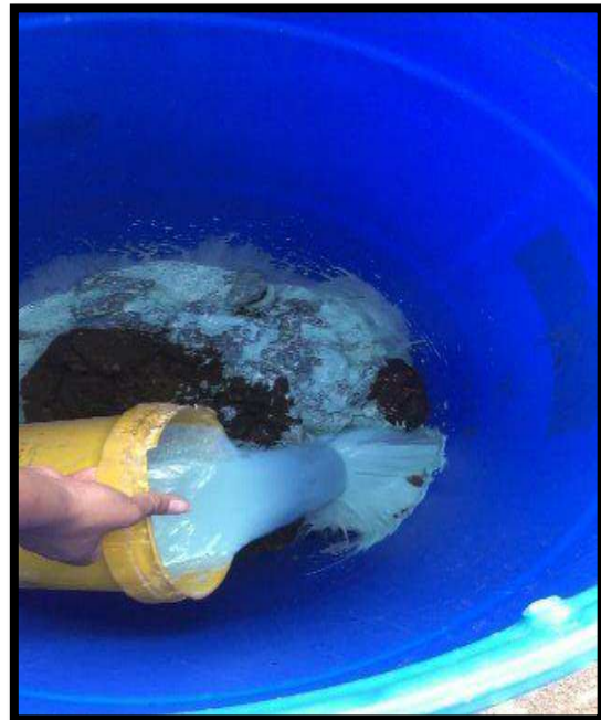
Figura 5: Incorporación cal agrícola y sulfato de cobre junto a el estiércol bovino previamente incorporado a el tanque.
