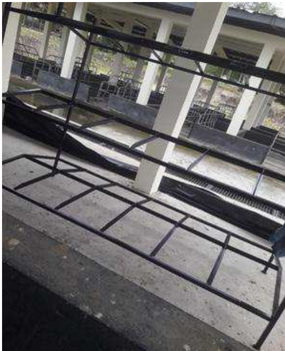
Foto 2: Perchas de 3 niveles con capacidad para 36 bandejas forrajeras
