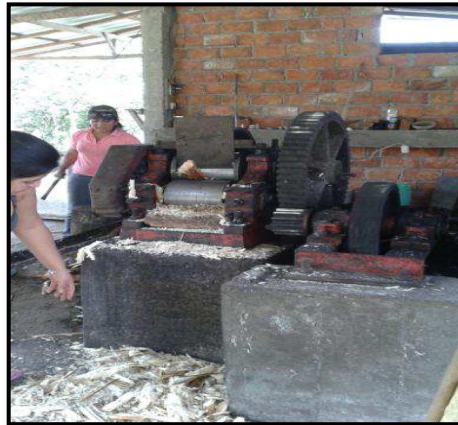
GRÁFICO 32. Extracción del jugo de la Caña (Uso del trapiche)
