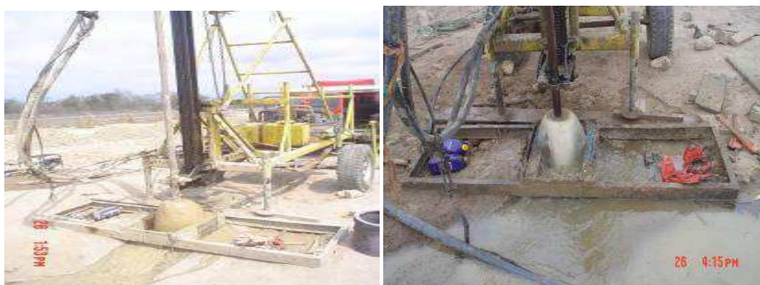
Grafico 25: Tuberías de perforación sin brocas. Fuente: Terreno Los Bajos-Montecristi Realizado por: Victoria Pillasagua
