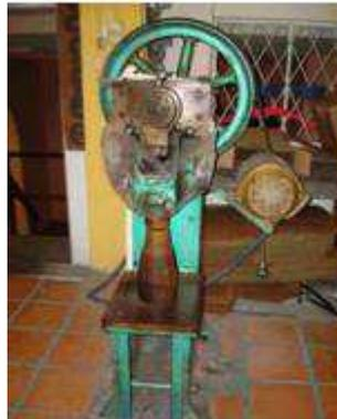
**Prensadora:** Esta máquina se la consigue en la ciudad de Guayaquil y es de origen brasileño. Para su funcionamiento utiliza: electricidad, agua y gas. Con el manejo de esta máquina se ha ido simplificando mucho el trabajo del compositor dejando a tras las planchas de carbón y las hormas de madera, ya que en cuestión de 20 a 30 segundos se obtiene la talla y forma del sombrero. La cantidad estimada que puede procesar en el día es de 40 docenas.
