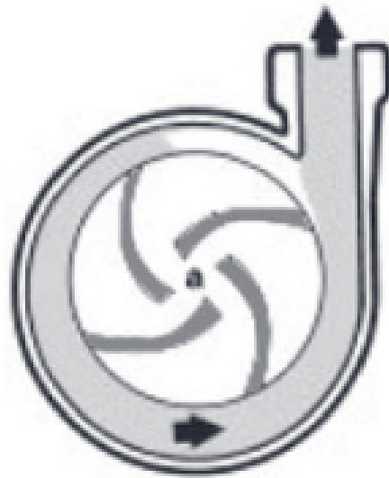
Caracol de la bomba centrífuga
