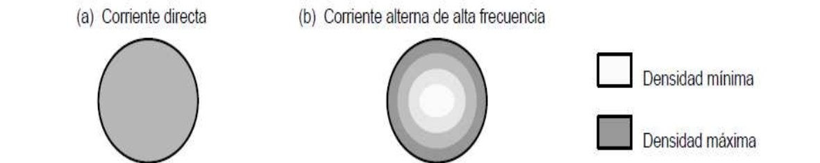
FIG. 7 Densidades de corriente en un mismo conductor (a) corriente directa (b) corriente de alta frecuencia.
