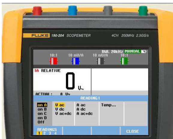
Figura 34. Panel de Medición de voltajes
