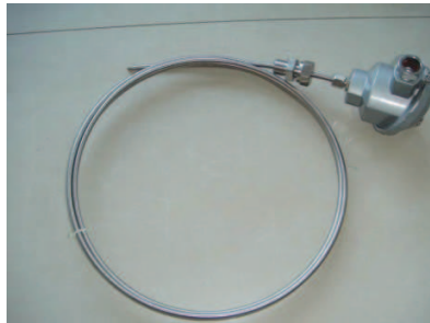
Figura. Montaje Pt100 en termo pozo.
