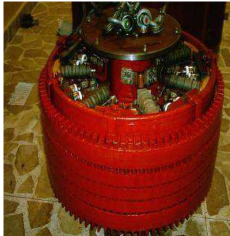
Figura 1.6. Bobinado rotativo de la excitatriz con sus diodos rotativos
