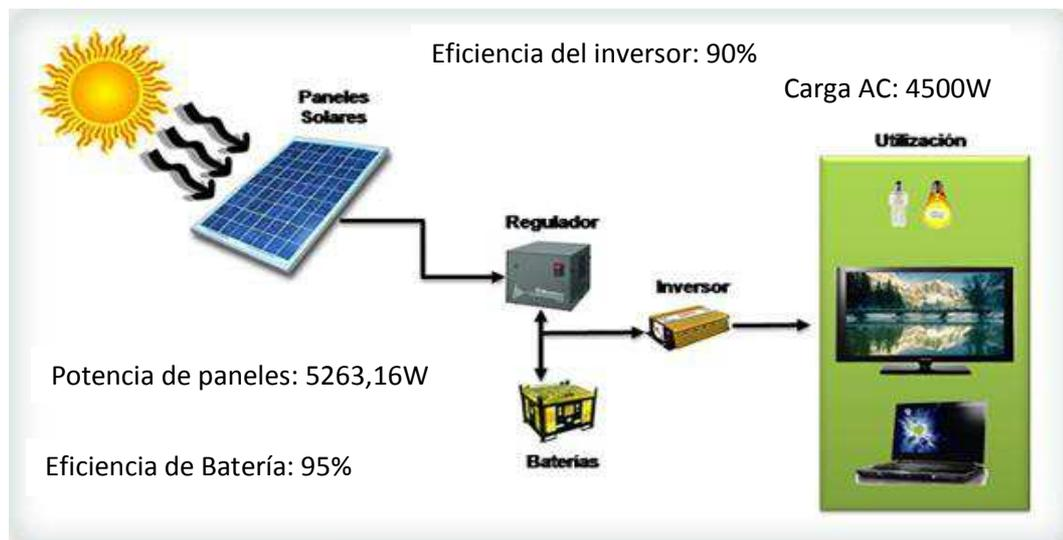
**Figura de la composición básica del sistema fotovoltaico 5Kva – 240V.**
