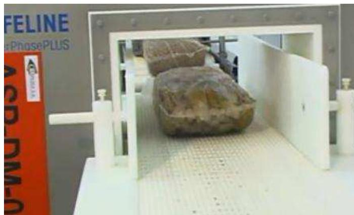
Las bolsas a través de una banda transportadora pasan por un equipo detector de metales para verificar que las lonjas de lomos y rallado precocidos no hayan tenido
