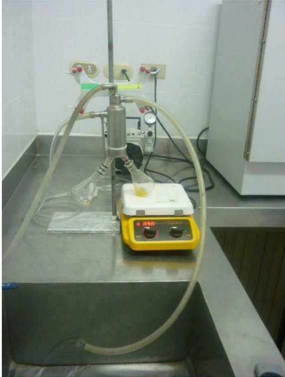
La bomba de vacío (5), generará el ambiente interno para que la temperatura a la que se destile el aceite sea menor, entre mayor cantidad de vacío exista dentro del sistema menor será la temperatura utilizada.
