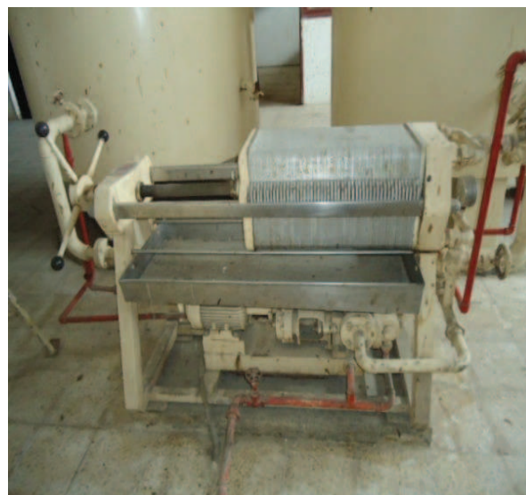
(Figura 6.- Tanques decantadores DCV-C50 y Filtro de manteca de cacao, marca Carle & Montanari)
