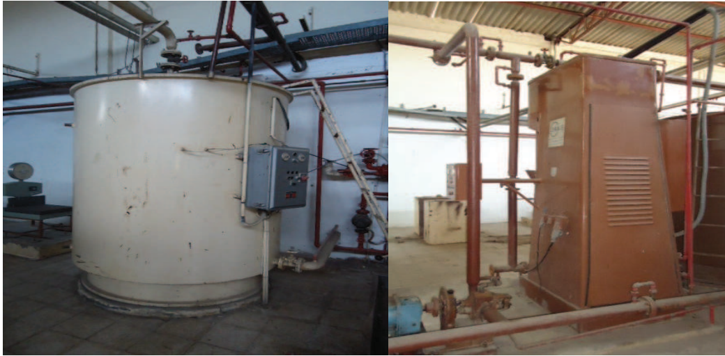
(Figura 7.- Tanque AM/50 para recepción de manteca y un rompe torta de cacao marca Carle & Montanari)
